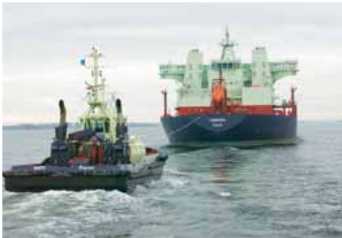
Fortum hoitaa raakaöljyn ja öljytuotteiden merikuljetuksia Itämerellä, Pohjanmerellä ja Pohjois-Atlantilla. Fortum käyttää öljykuljetuksissaan ainoastaan kaksoisrungolla tai -pohjalla varustettuja säiliöaluksia. Vuonna 2002 Fortum otti käyttöönsä uuden 106 000 tonnin superjääluokan raakaöljyaluksen samoin kuin kaksi uutta saattohinaajaa. Toinen samanlainen raakaöljyalus otettiin käyttöön tammikuussa 2003. Kaikkiaan Fortumin laivastoon kuuluu noin 30 alusta.
