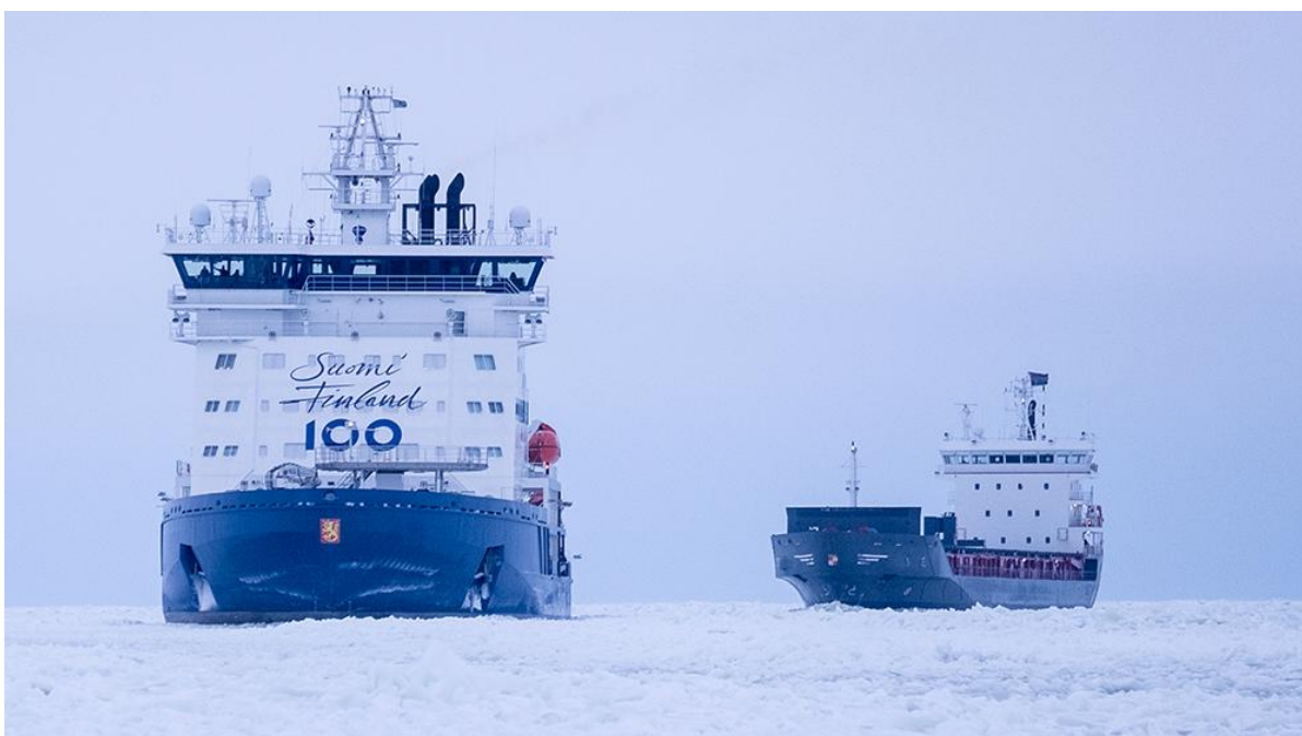
Polaris, maailman ensimmäinen jäänmurtaja joka voi käyttää polttoaineenaan vähärikkisen dieselin lisäksi nesteytettyä maakaasua (LNG). Kuva: Timothy Bird
